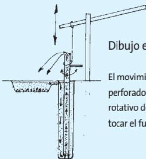
Dibujo esquemático del Rota-sludge.
