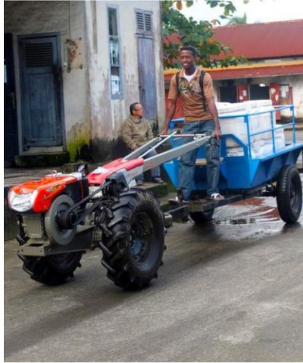
Fig.5 Transport des boues en mini-tracteur
