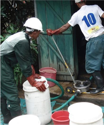
Fig.4 Pompe à diaphragme manuelle
