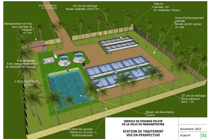
Fig.4 Conception APS d'une unité de valorisation énergétique et agricole des boues pour la ville de Maroantsetra (Madagascar)
