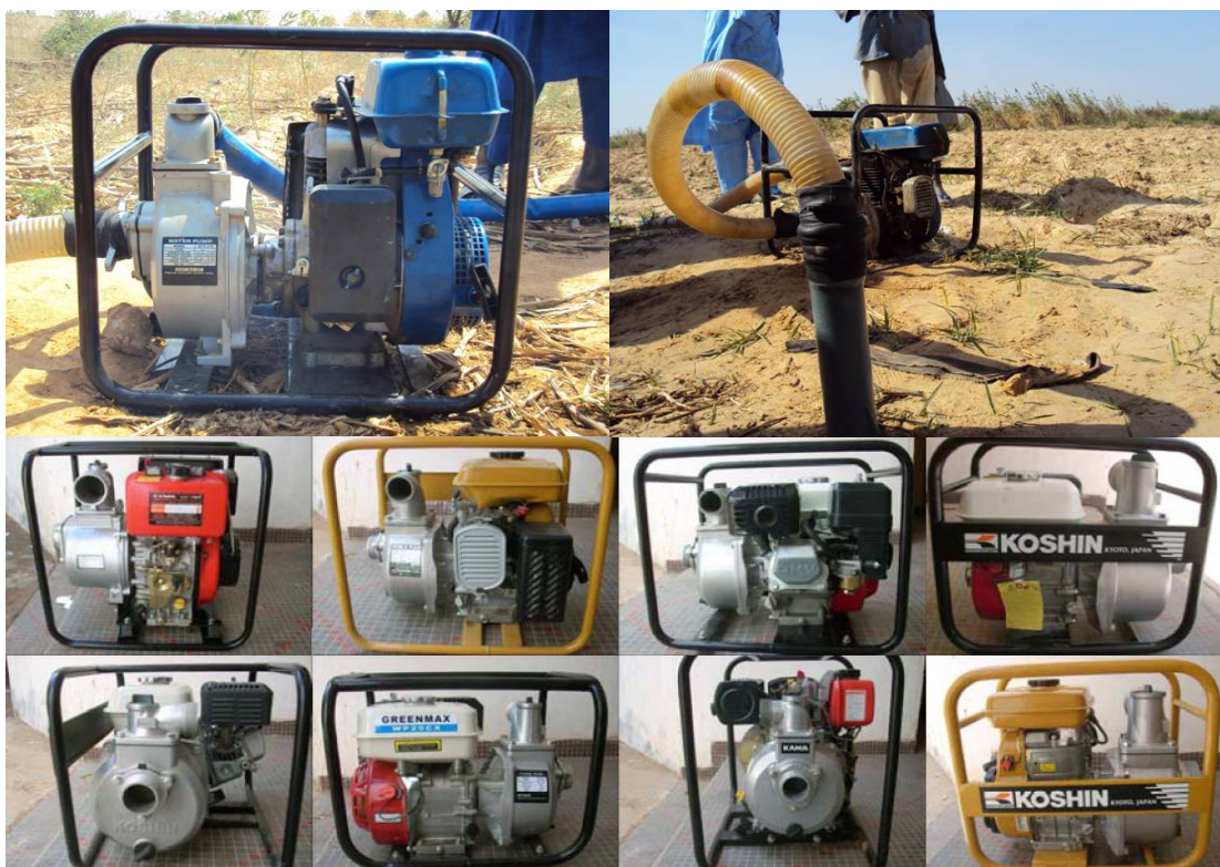
Figure 7. Gamme de motopompes faible puissance de 3 à 5 CV
