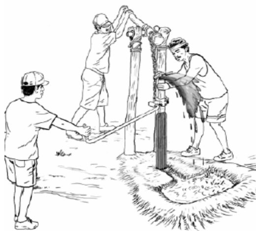
Figure 3. Forage à la boue : le rota sludge
