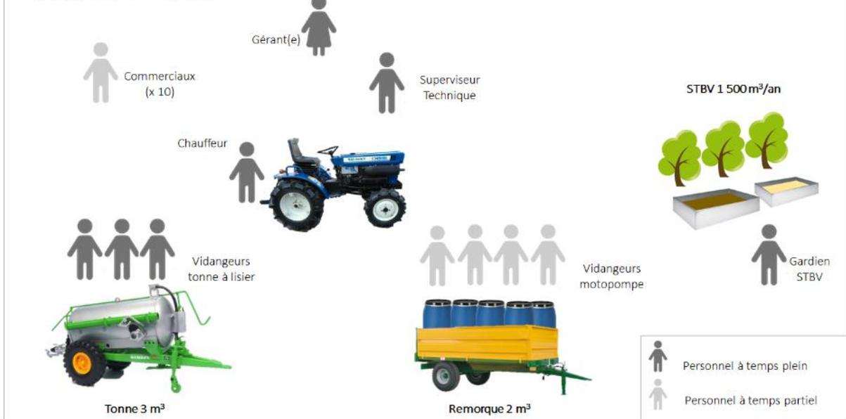
Figure 7 : Récapitulatif des RH à mobiliser pour la fourniture du service de vidange (capacité : 1 500 m<sup>3</sup>/an)
