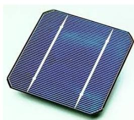
Les cellules peuvent être rondes, carrées ou d'autres formes. Chaque cellule produit environ 0,5 volts, quelle que soit sa taille. La quantité d'ampères qu'une cellule peut produire dépend de sa taille : les grandes cellules produisent plus d'ampères. De nombreuses cellules doivent être connectées en série pour produire une tension suffisamment élevée. Habituellement, il y a 30 à 36 cellules sur un panneau destinées à charger une batterie de 12 V.
