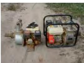
Une motopompe (1) Puissance de 3,5-4,5 CV, diamètre aspiration/refoulement 2" (Capable de pomper 15-20 m<sup>3</sup>/h)
