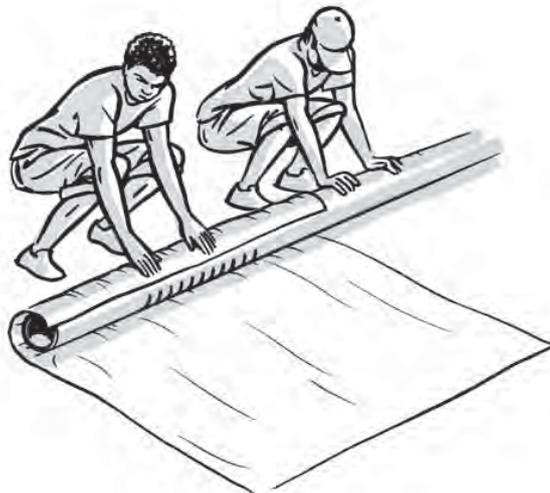
Envelopper fermement la crépine de 3 couches de géotextile. Attacher le géotextile avec du fil en nylon ou une cordelette formant une spirale.
