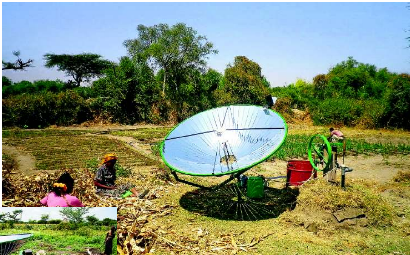
De stoompomp op zonne-energie maakt het mogelijk om akkertjes te bebouwen op plaatsen waar gewoonlijk te weinig regen valt voor tuinbouw.
